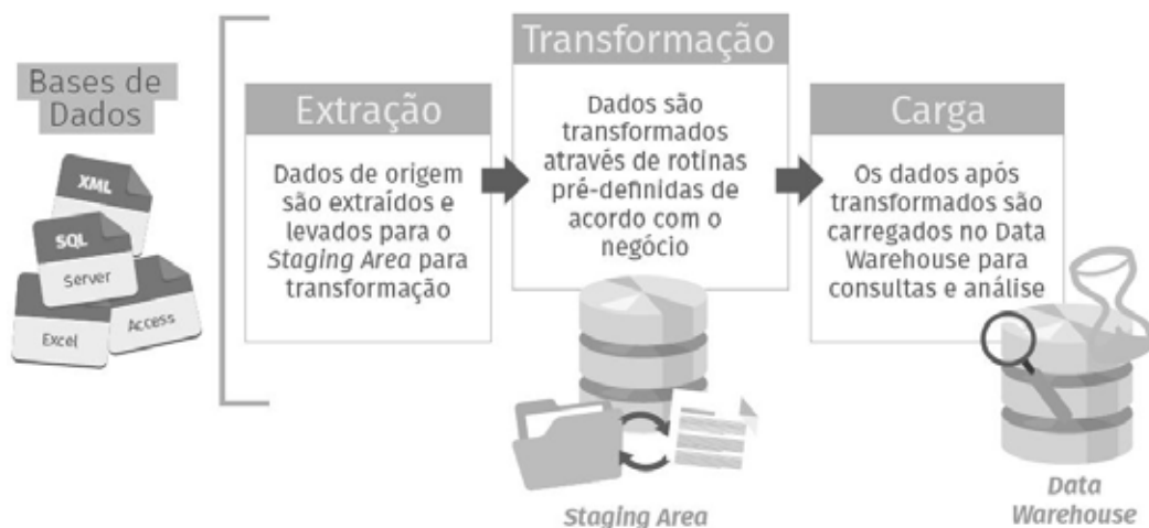
FIGURA 7 – ESQUEMA DA INFRAESTUTURA DE UM SISTEMA ETL
