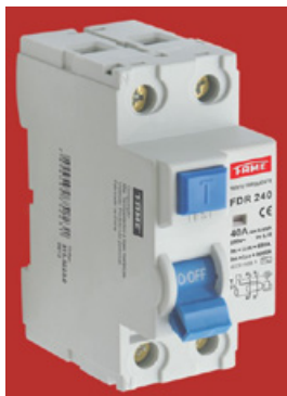
FIGURA 24 – DISPOSITIVO DR INTERRUPTOR DIFERENCIAL FD DISJUNTOR 2P 40A 30MA - CONDUTOR 16MM 2
