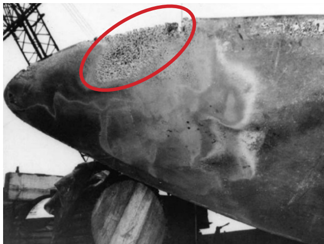
FIGURA 4 – EROÇÃO DA SUPERFÍCIE DE UMA HÉLICE
