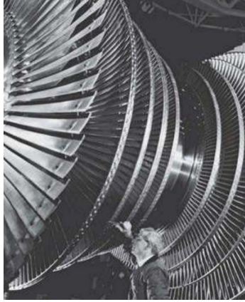
FIGURA 27 – TURBINA A VAPOR DE DOIS ESTÁGIOS
