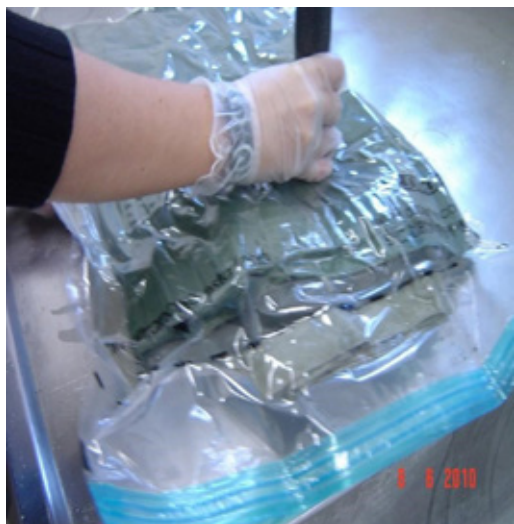
FIGURA 20 – ACONDICIONAMENTO COM SUCÇÃO A VÁCUO
