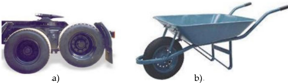
FIGURA 27 - EIXOS NÃO TRACIONADOS DE VEÍCULO (A) OU EQUIPAMENTO (B)
