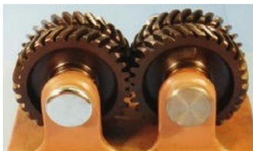
FIGURA 37 - MONTAGEM DE UM PAR DE ENGRENAGENS HELICOIDAIS PARA EVITAR ESFORÇO AXIAL
