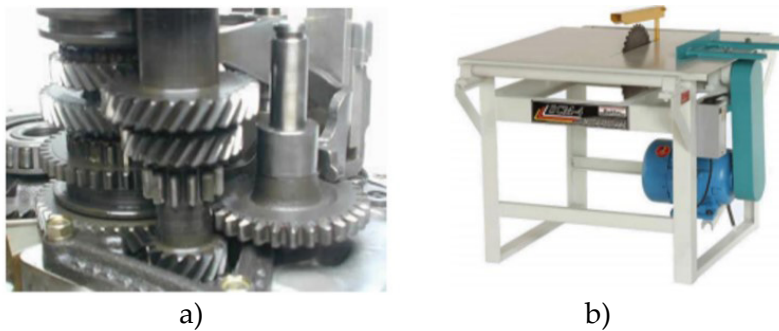
FIGURA 29 - EXEMPLOS DE ARVORE DE EIXOS, CAIXA DE TRANSMISSÃO DE UM VEÍCULO (A), OU UM EIXO DE UMA SERRA CIRCULAR (B)
