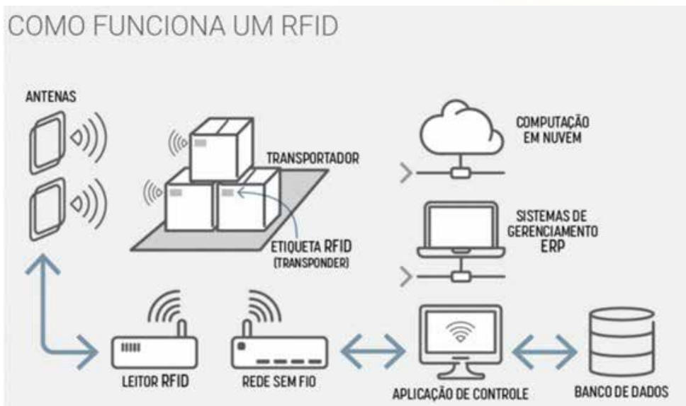
FIGURA 7 - COMO FUNCIONA O SISTEMA RFID
