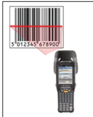
FIGURA 10 - LEITOR PORTÁTIL DE CÓDIGO DE BARRAS WMS
