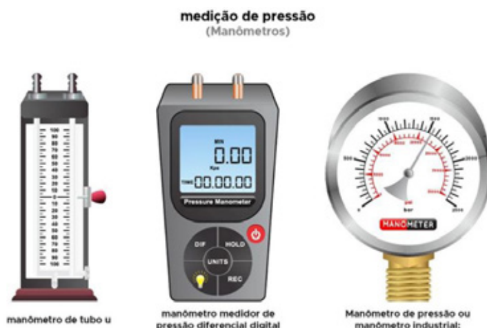
FIGURA 10 – MEDIDOR DE PRESSÃO (MANÔMETRO)
