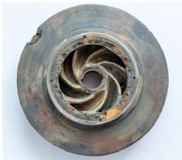
FIGURA 16 – ILUSTRAÇÃO DE UM ROTOR OU IMPULSOR COM DESGASTE PROGRESSIVO
