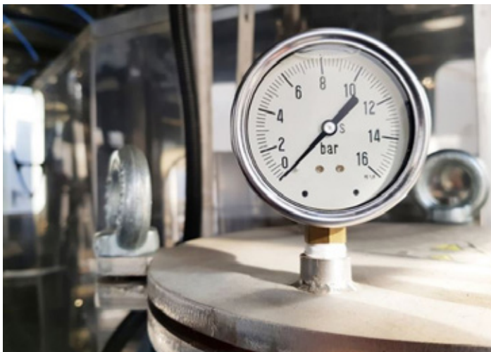
FIGURA 9 – MEDIDOR DE PRESSÃO (MANÔMETRO)
