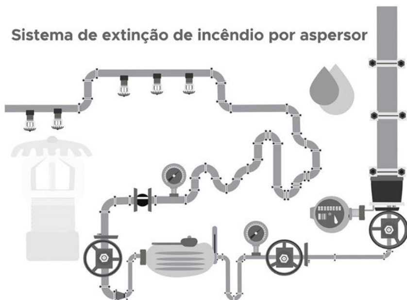
FIGURA 14 – SISTEMA DE AUTOMAÇÃO DE COMBATE A INCÊNDIO POR ASPERSOR
