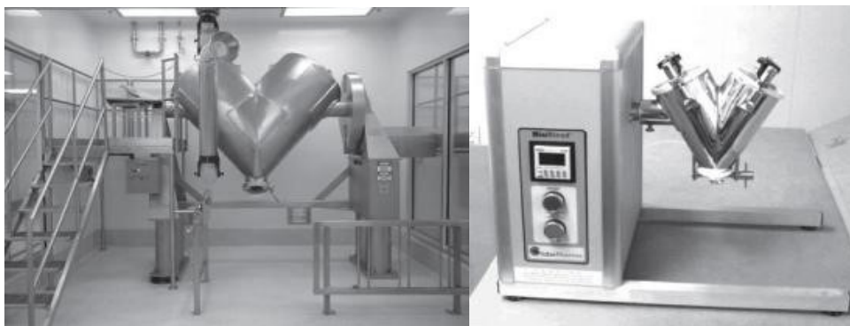
FIGURA 4 – EXEMPLOS DE MISTURADORES DE PÓ POR TOMBAMENTO EM "V", EM ESCALA INDUSTRIAL E DE BANCADA
