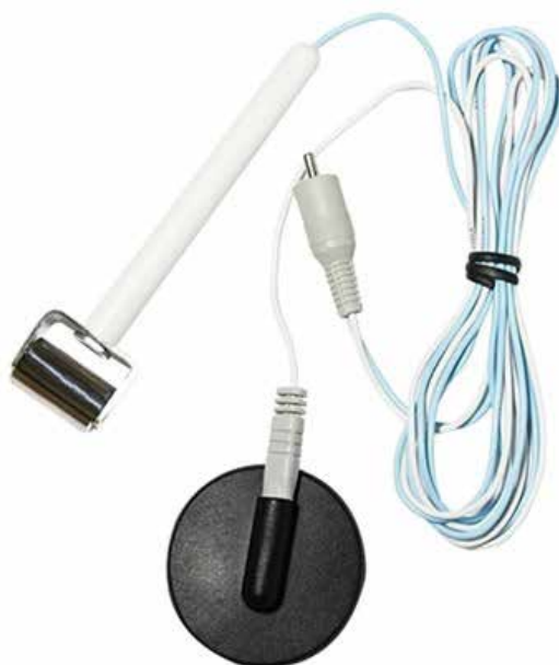
Figura 4 – Eletrodo tipo rolo, utilizado como eletrodo ativo
