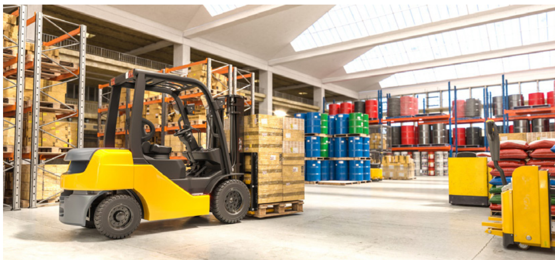
Figura 7 – Empilhadeira, estantes e paletes: equipamentos de armazenagem
